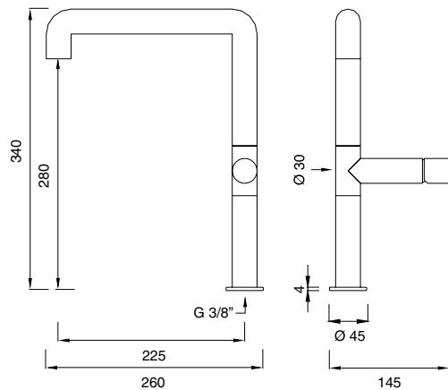
Portata aeratore 5 l/min / 1.3 gpm, risparmio idrico
